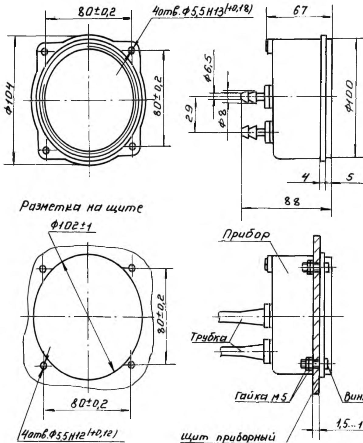
Рисунок 4 – Габаритные и присоединительные размеры приборов
