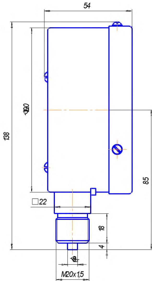
Рисунок 6 – Габаритные и присоединительные размеры прибора
