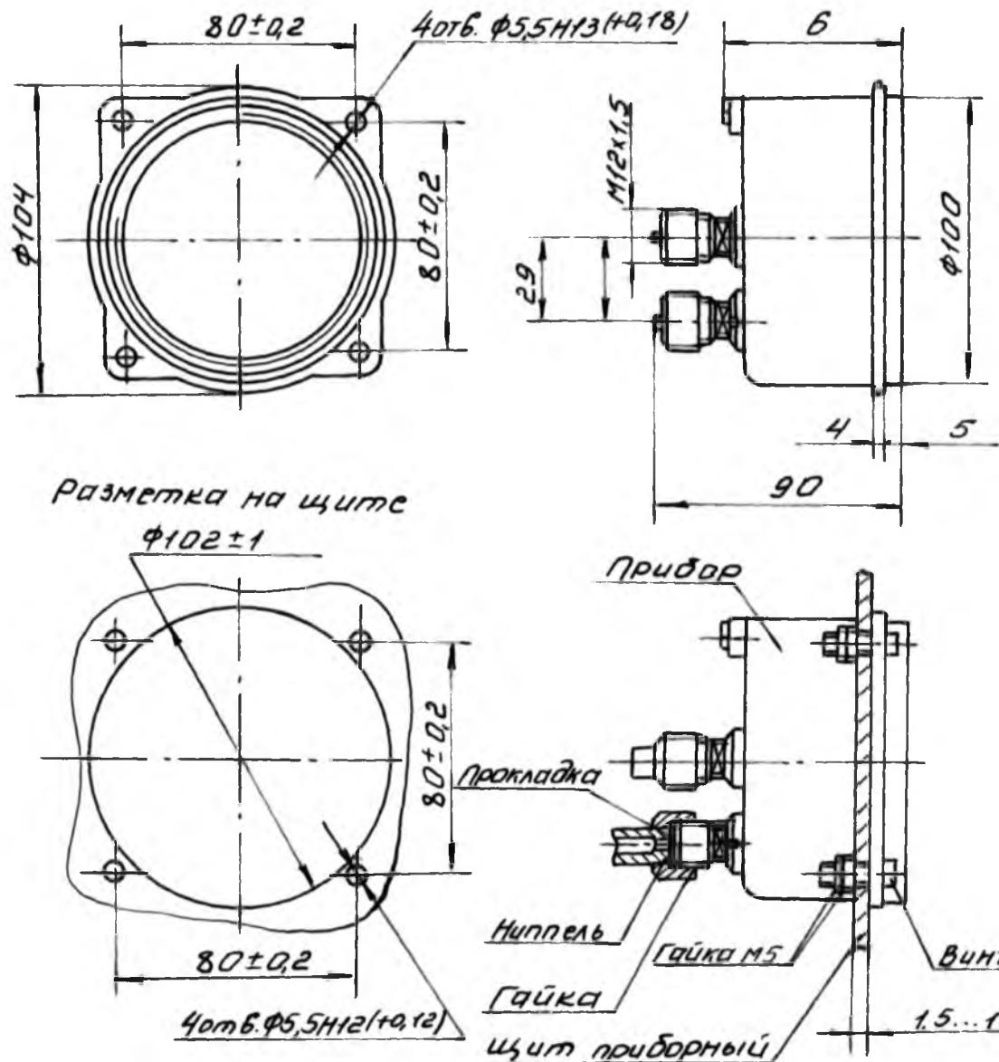
Рисунок 5 – Габаритные и присоединительные размеры приборов
