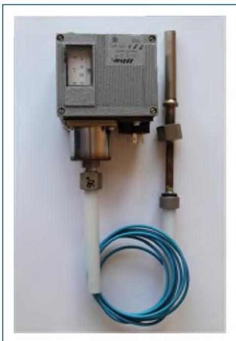
**Датчики-реле температуры ТАМ-102С** предназначен для использования в холодильных установках, а также в других системах для контроля и регулирования температуры газообразных и жидких сред (воздух, хладагенты, масла и др.), неагрессивных к меди и медным сплавам, оловянно-свинцовому, серебряным припоям, сталям.
