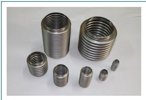
**Сильфоны многослойные** предназначены для работы в качестве чувствительных элементов, разделителей сред, уплотнительных устройств, а также элементов силового узла в средах, не вызывающих коррозии материала, при температуре от минус 260°С до плюс 550°С.
